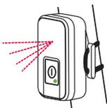
Das VDO Rücklicht ist ein sensorgesteuertes, selbstkalibrierendes Verzögerungslicht. Die Kalibrierung erfolgt bei jedem Einschalten und wird durch eine ca. 3 sec. grün leuchtende LED angezeigt.
