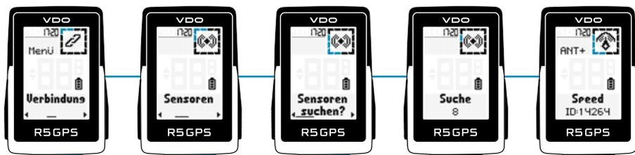
Haben Sie bereits Sensoren verbunden, können Sie mit Auswahl von Verbindung > Sensoren sowohl neue Sensoren hinzufügen, als auch die bestehenden Sensoren einsehen und verwalten.
